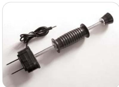
Normale Hammerelektrode - BLD5000
