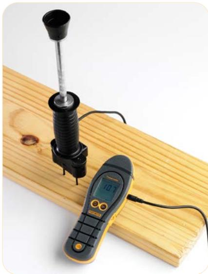
Wenn absolut präzise Feuchtemessungen bei Holzprodukten gefordert sind, gibt es keinen Ersatz für das **Protimeter TimberMaster**
