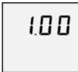
Lassen Sie beide Tasten los, während die Versionsnummer angezeigt wird. Das Gerät wechselt in den Einstellungsmodus.
