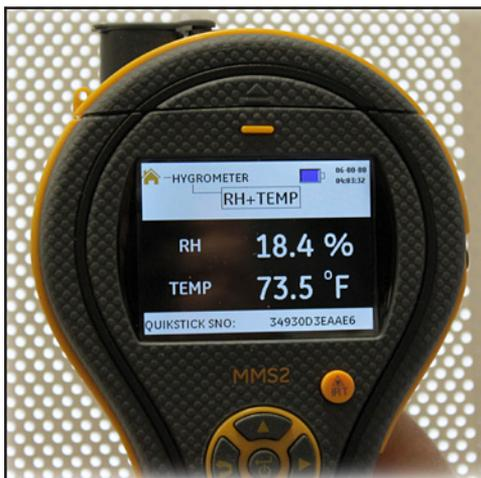
Figura 4: MMS2 con funzione di igrometro
