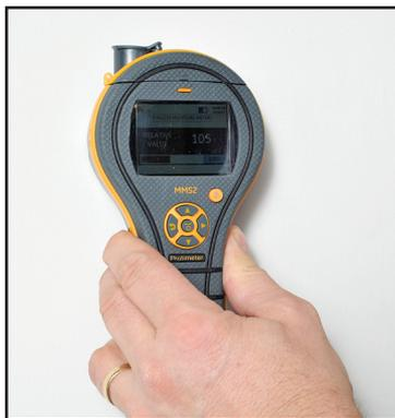
**Figura 3:** Misurazione dell'umidità relativa
