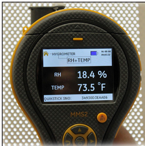
Figur 4: MMS2 som hygrometer
